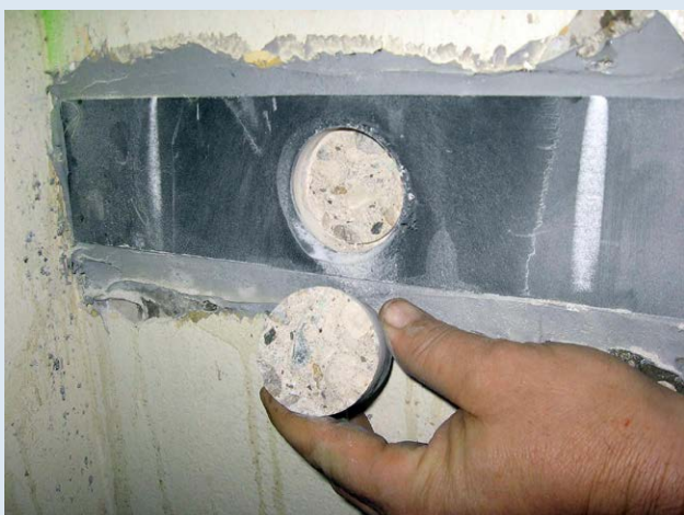
Sliki 27 in 28: Med odtržnim preizkusom se mora stik porušiti po osnovnem materialu (levo), in ne po lepilu (desno).
