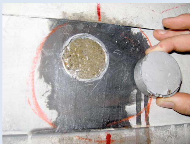
Sliki 27 in 28: Med odtržnim preizkusom se mora stik porušiti po osnovnem materialu (levo), in ne po lepilu (desno).
