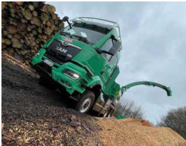
Slika 2: Mobilni drobilnik JENZ Chippertruck
