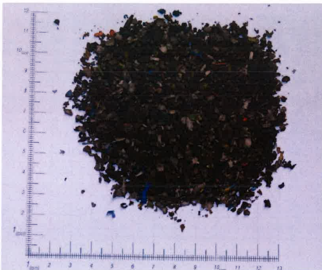
Slika 4: Primer obdelane ločene frakcije plastike in gume z števil 19 12 04 za nadaljnjo uporabo
