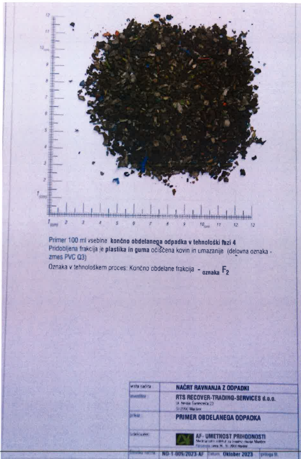
Slika 7: PRIKAZ OBDELANEGA ODPADKA – FRAKCIJA F2- z številko 19 12 04 Končno obdelana ločena frakcija, zmes plastike, gume, kablovodne izolacije zmes PVC Q3.
