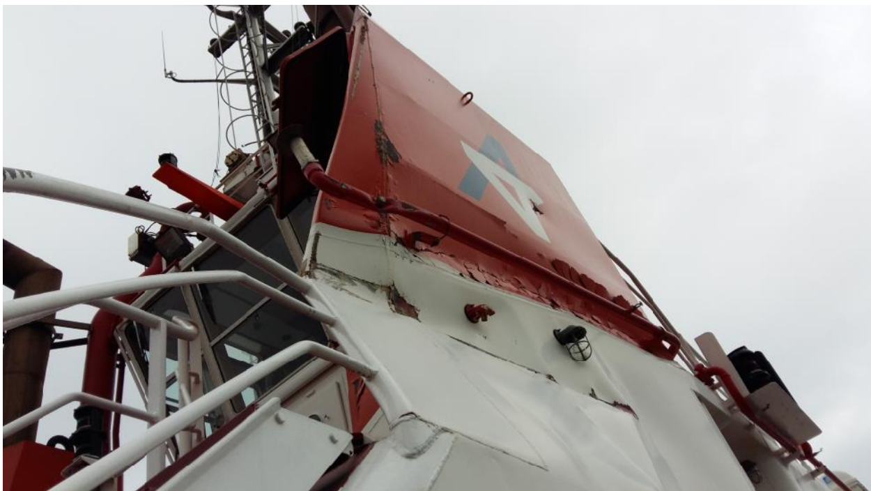
Slika 20: Poškodba nadgradnje na vlačilcu NEPTUN
