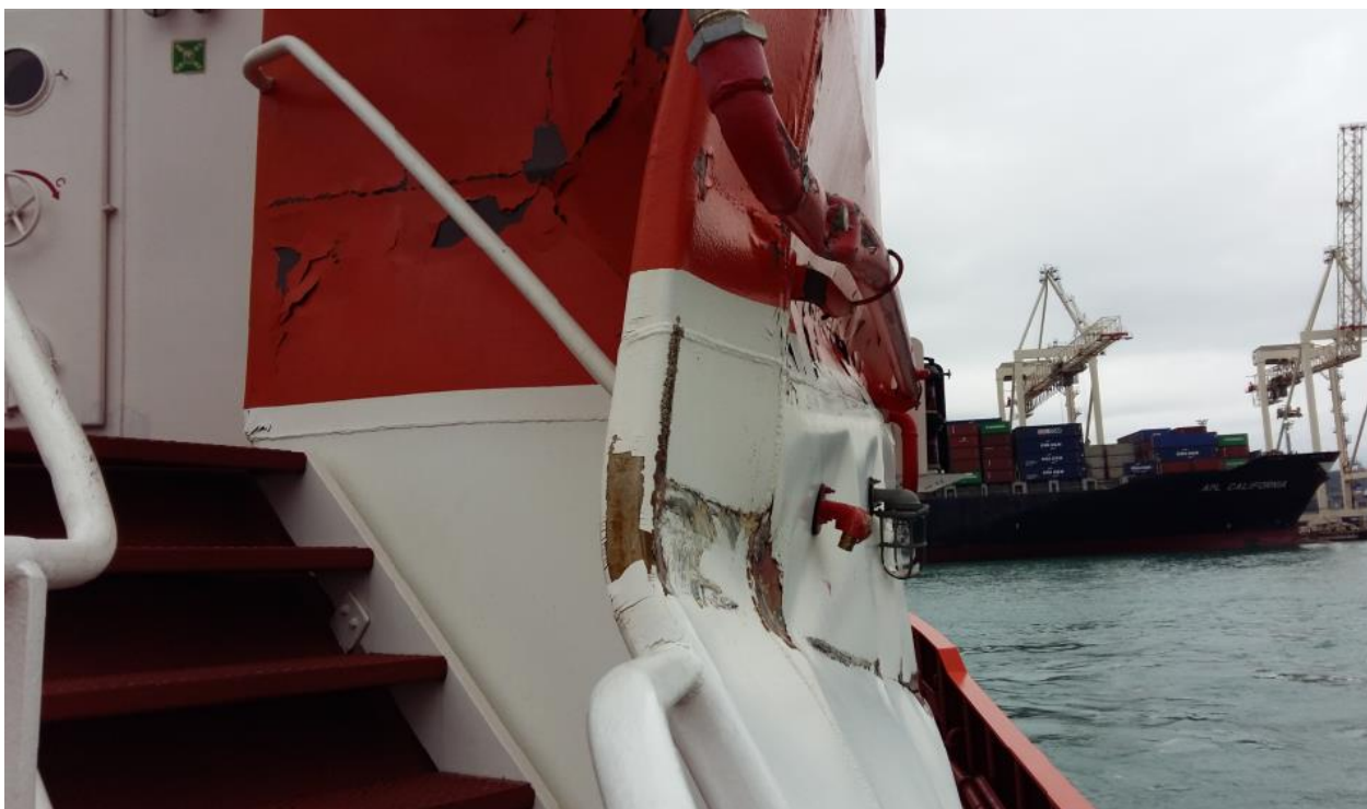
Slika 21: Poškodba nadgradnje na vlačilcu NEPTUN
