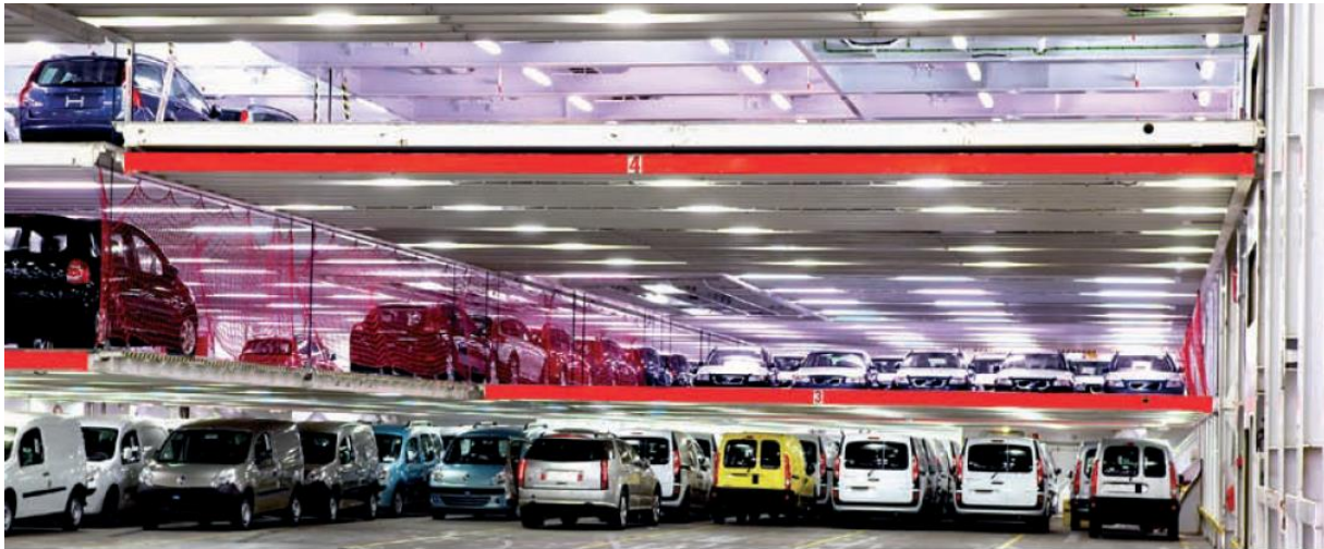
Slika 4 Sistem prilagodljivih dvižnih palub na Ro Ro ladjah (Vir: MacGregor)
