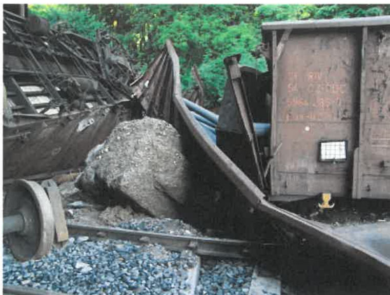
Slika št. 1: Prikazuje uničene vagone, ki so se nagrmadili v zaključku tira št. 601 postaje Kranj
