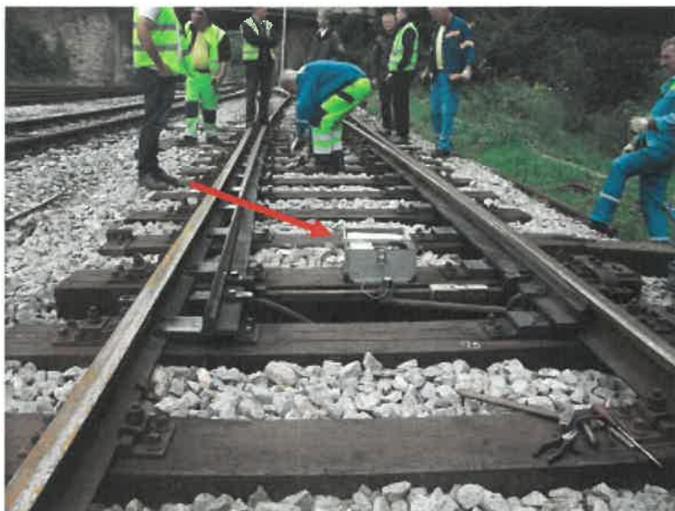
Slika št. 7: Rdeča puščica prikazuje napravo za merjenje sil nasilne prestavitve ostrice kretnice
