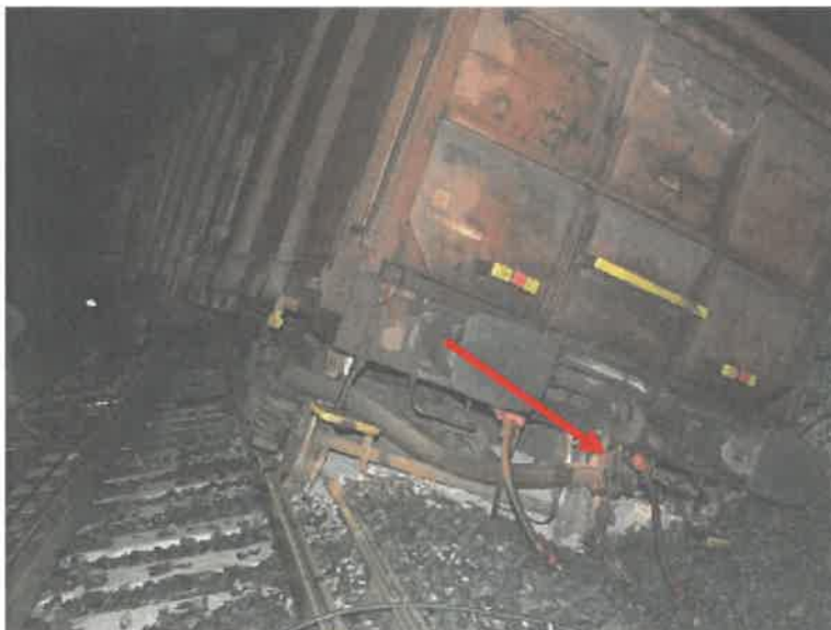
Slika št. 8: Rdeča puščica prikazuje odprto pipo glavnega zračnega voda na sklepu četrtega iztirjenega vagona po zaustavitvi dela vlaka št. 49485 na kretnici št. 1 postaje Kranj, dne 11.6.2018
