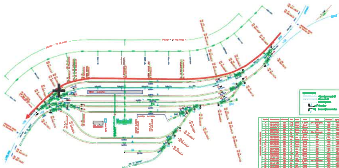
Slika št. 3: Rdeča puščica prikazuje vožnjo vlaka 49485 preko področja postaje Kranj, črn križ pa mesto iztirjenja na kretnici št. 6
