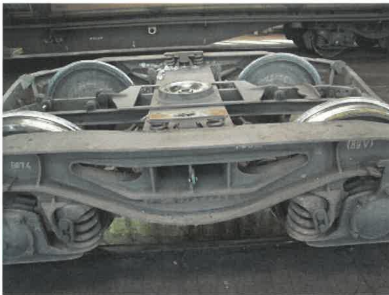
Slika št. 10: Izvlečen podstavni voziček B med pregledom iztirjenega vagona vlaka št. 49485 na kretnici št. 6 postaje Kranj, dne 11.6.2018
