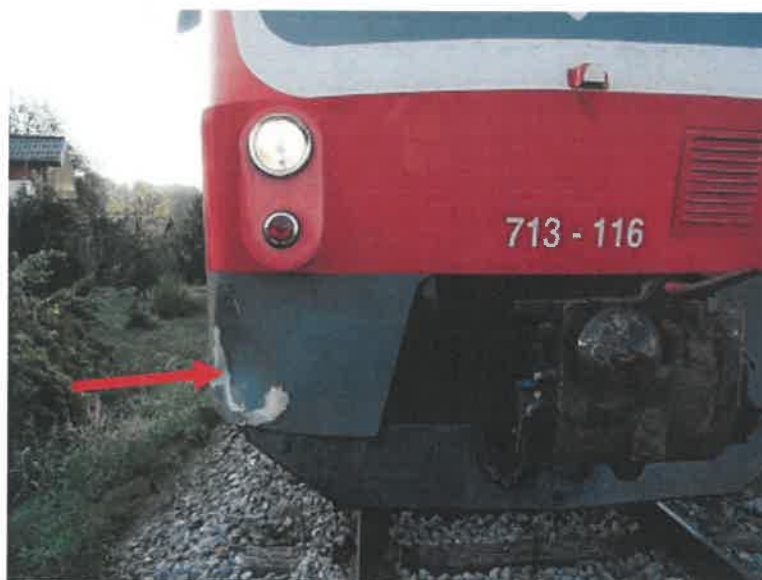
Slika št. 2: Rdeča puščica označuje poškodbo, ki je nastala po trčenju vlaka št. 3204 v občanko
