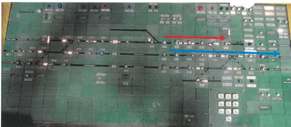
Slika št. 4: Stanje na mizi ERSV naprave po nesreči, na tiru št. 3 in varovalnem slepem tiru št. 103 se nahaja iztirjen vlak št. 499, kar je označeno z rdečo puščico. Potniški vlak št. 5055 je prometnik po prejtem obvestilu, da je vlak 499 iztiril odpravil iz tira 2 proti Litiji, prikazano z modro puščico.
