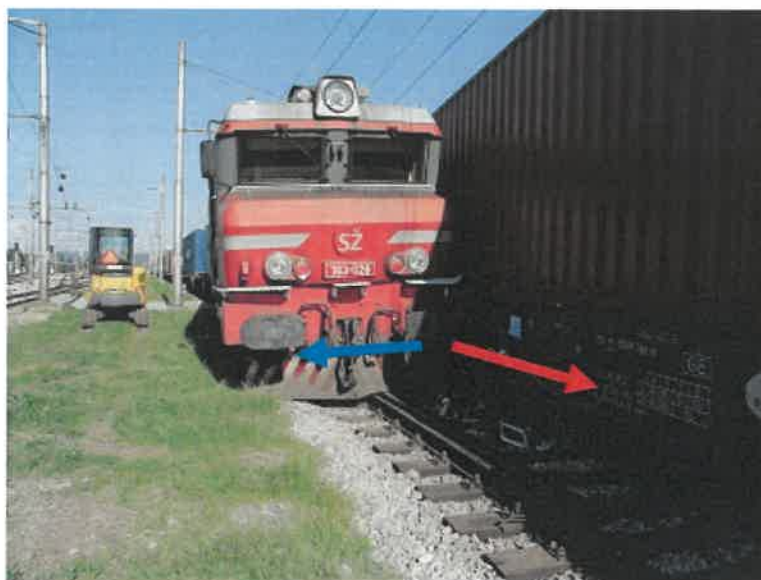
Slika št. 3: Rdeča puščica prikazuje smer vožnje vlaka 42021 z lokomotivo 363-026, modra pa smer iztirjenja ob počnem trčenju z lokomotivo 541-107 vlaka št. 93600.
