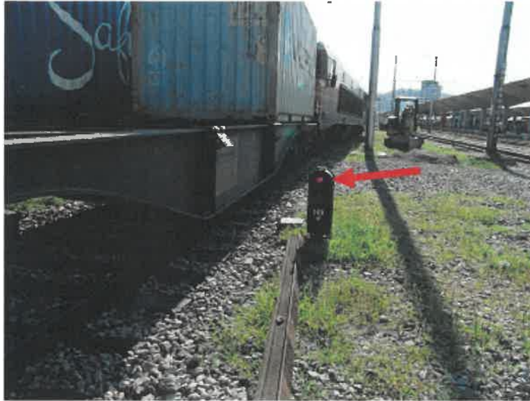
Slika št. 4: Rdeča puščica prikazuje premikalni signal 149 a, ki je pred vožnjo vlaka št. 42021 kazal signalni znak 28: »Premik prepovedan«.
