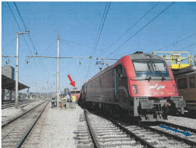
Slika št. 5: Modra puščica prikazuje smer vožnje vlaka št. 93600 rdeča pa iztirjeno lokomotivo vlaka št. 42021 na križiščni kretnici 149 ab/cd.
