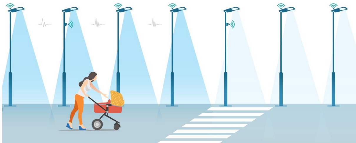
Slika 52: Prikaz delovanja pametne (dinamične) razsvetljave, kjer se ustrezne razmere zagotavljajo glede na prisotnost udeležencev v prometu s pomočjo senzorjev in komunikacije med svetilkami in nadzorno postajo
