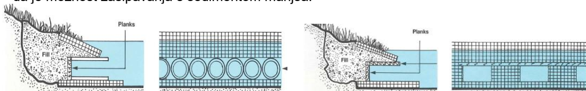
Slika 11: Primer umetno ustvarjenih skrivališč za ribe, izvedenih kot luknje v brežini (privzeto iz Rehabilitation of rivers for fish, FAO 1998).
