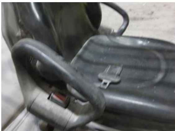
Slika 7: Odrezan vtičnik varnostnega pasu na viličarju
