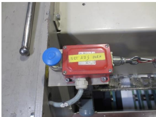
Slika 5: Stikalo za izklop v sili ni prave barve in napisi so v nemškem jeziku
