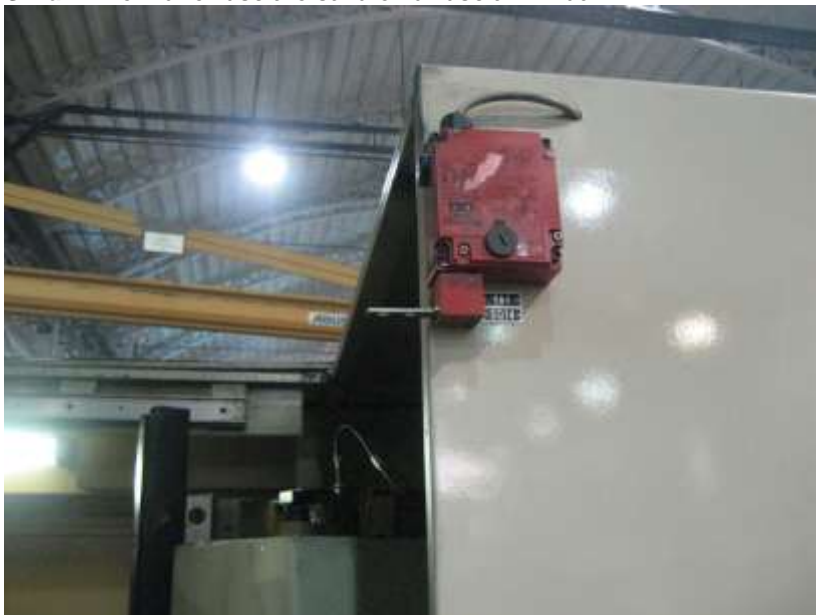
Slika 2: Blokirano zaščitno stikalo na zaščitnih vratih
