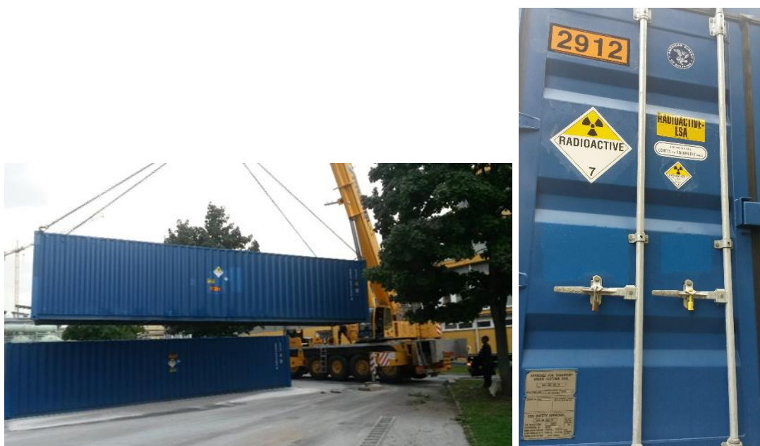
Slika 18: Manipulacije ISO kontejnerja z dvigalom v Cinkarni Celje, d. d. (levo), oznake na ISO kontejnerju in plomba (desno) (Foto: inšpekcija URSJV)
