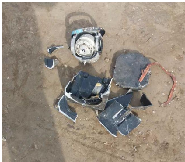
Slika 16: Številčnica žiroskopskega navigacijskega inštrumenta z radiofluorescenčno barvo z radionuklidom ^{226}\text{Ra} najdena med sekundarnimi surovinami, ki je povzročila tudi kontaminacijo tal (Foto: ZVD d. o. o.)
