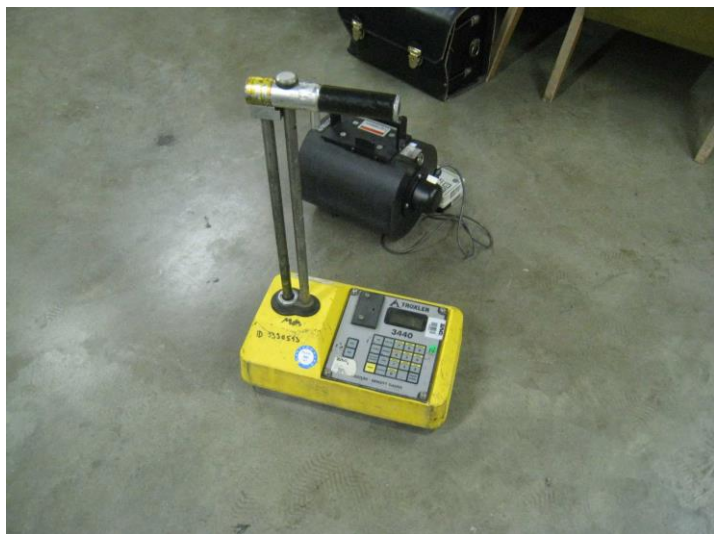
Slika 14: Sonda TROXLER 3440, pri kateri je prišlo do okvare pomičnega mehanizma (Foto: ZVD d. o. o.)
