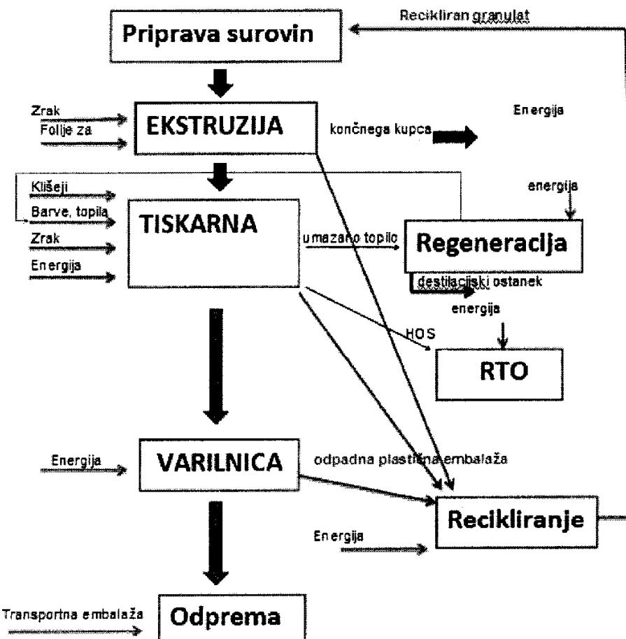
Proizvodni procesi so tehnološko zaključeni, proizvodnja poteka na posameznih tehnoloških linijah, ki so nameščene v treh proizvodnih enotah: obrat ekstruzija, obrat tiskarna in obrat varilnica.
