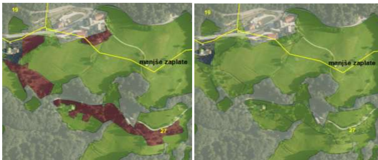
Slika 26: Primer v naselju Gorenji Novaki. Model je izkazal predlog TVKZ zaradi trajnega nasada. Boniteta in nagib terena nakazujejo na predlog OKZ, tudi v primeru večjega poligona (0,96 ha).
