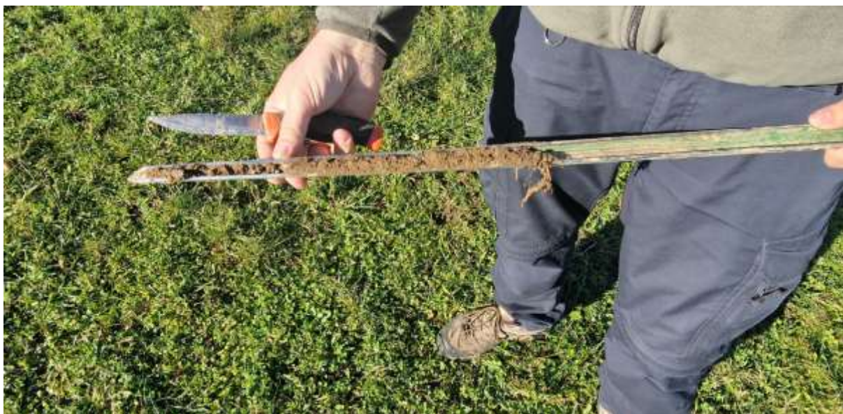
Slika 66: Sondiranje je na Šebreljski planoti mestoma izkazalo ustrezne globine tal.
