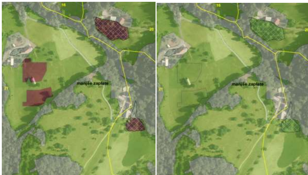
Slika 23: Primera zaokroževanja glede na velikost poligona. Na prvi sliki je rezultat modela, na drugi pa rezultat po zaokroževanju. Primer se nahaja v naselju Gorenji Novaki. Model vsebuje poligone velikosti od 0,2 ha do 0,3 ha zaradi manjših izravnjav ali ekstenzivnih trajnih nasadov. Smiselno je bil določen OKZ.
