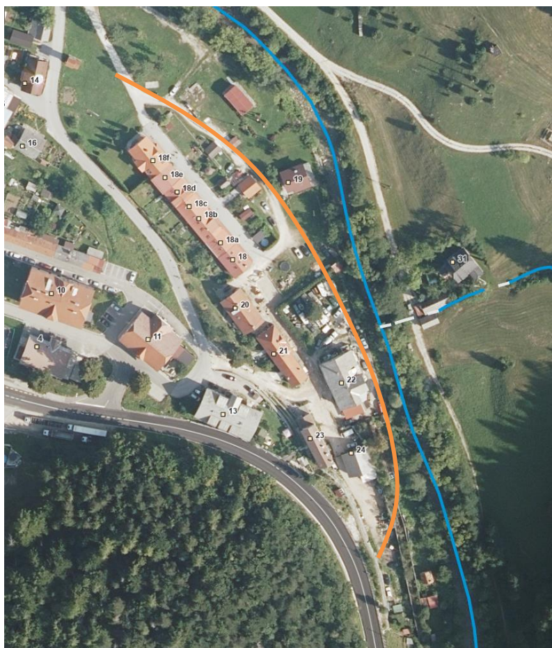
Slika 11: Možni ukrep izvedbe protipoplavnega nasipa/zidu
