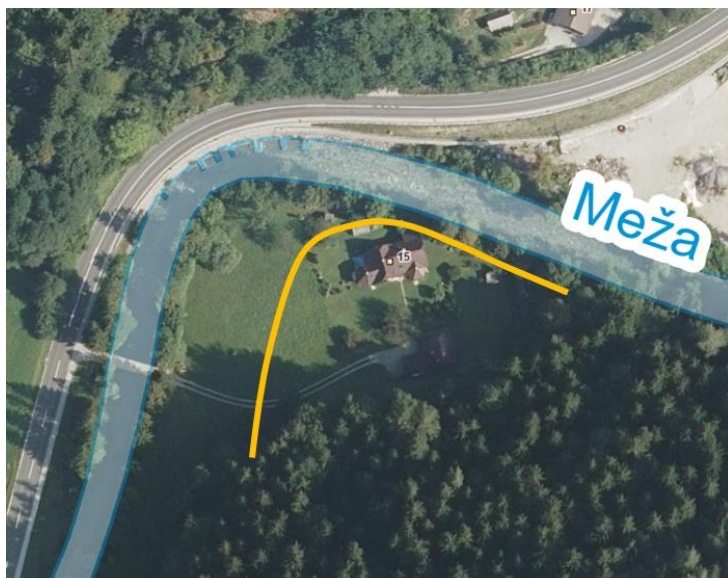
Slika 8: Primer ureditve visokovodnega zidu/nasipa na območju objekta
