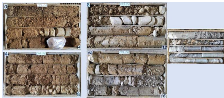
Slika 4: Vrtina OVR-PV2p – trdna podlaga se prične na globini 17 m – možna drsina do globine cca. 15 m. Izdelana bo karotaža za določitev smeri foliacije.
